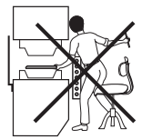
Eindringen in den Gefahrenbereich durch Übergreifen
