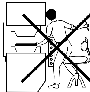
Pénétration dans la zone dangereuse par dessus la barrière
