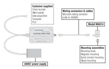
Model MAQ14 Accelerometer
