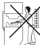
Penetración entre la barrera y la zona peligrosa
