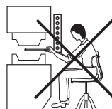
Penetración en la zona peligrosa por la parte inferior de la barrera
